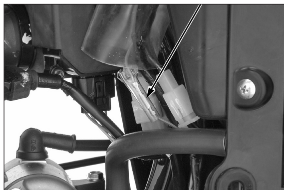
CONECTOR DA FIAÇÃO
