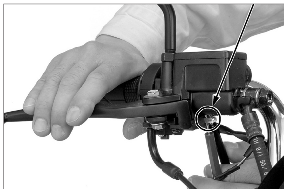
INTERRUPTOR DA LUZ DO FREIO DIANTEIRO
