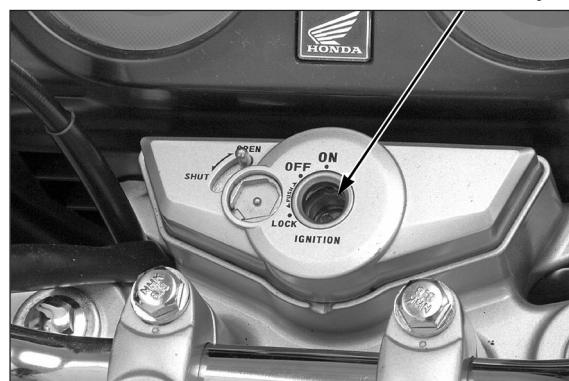
INTERRUPTOR DE IGNIÇÃO
